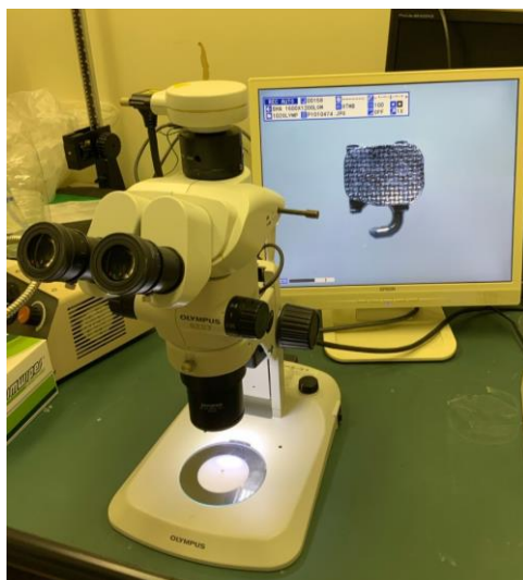
Figura19. Uso de estéreomicroscopio para calificar Índice de adhesivo remanente.
